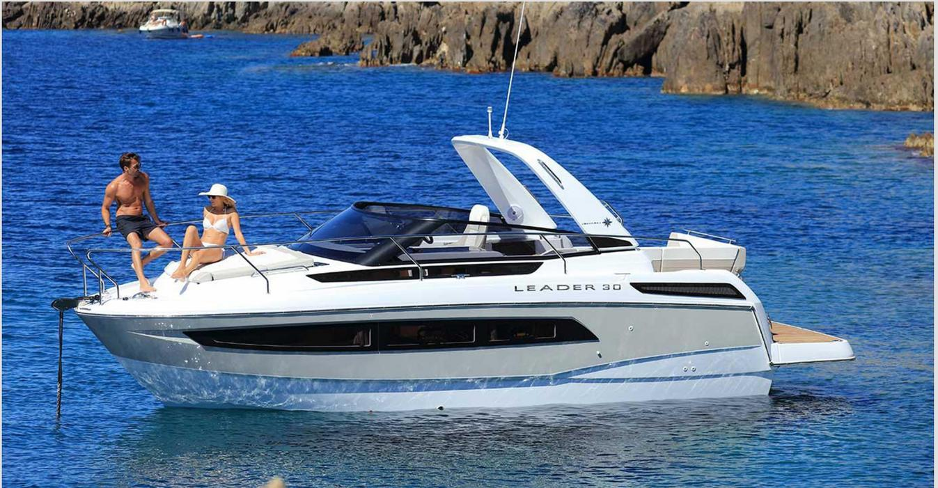
**Baujahr: 2019****Motor: Volvo D4 300 PS ZD DP (300 PS/Diesel)****Länge: 9,23 m****Breite: 2,98 m****Tiefgang: 0,60 m****Gewicht: 3.700 kg****Kraftstofftank: 300 l****Wassertank: 100 l**
